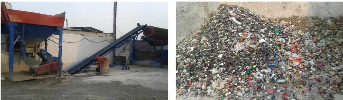
Figura 6 - Fotos de processo de limpeza e resíduos retirados do vidro
