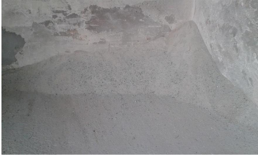
Figura 7 - Caco de vidro após o processo de reciclagem para ser vendido como a matéria prima final
