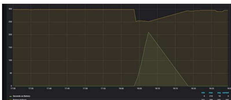
Figura 7 – Carga e descarga da bateria em um monitoramento de nobreak
