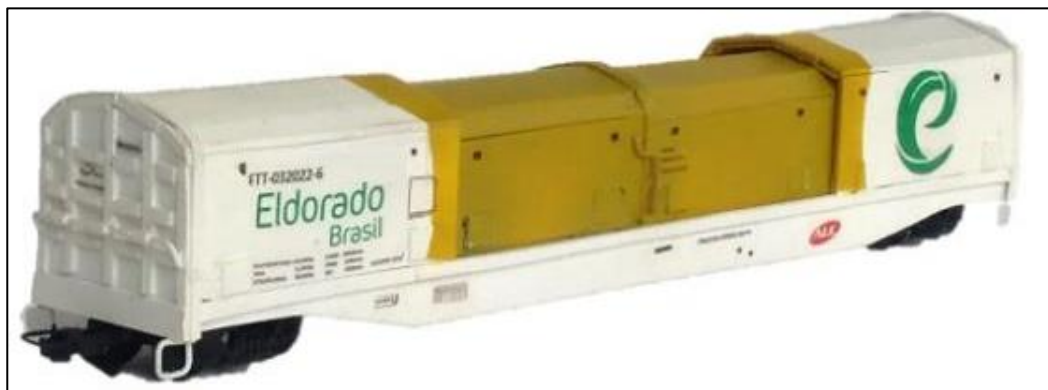
Figura 8 – Vagão telescópico FTT para o transporte de celulose
