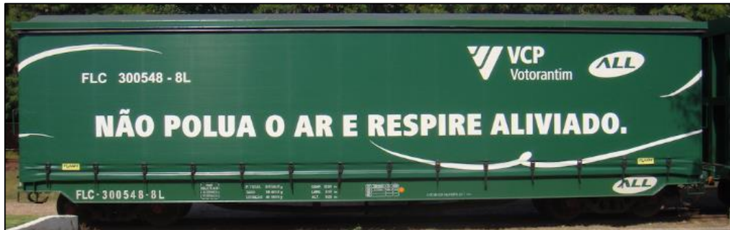
Figura 7 – Vagão sider para o transporte de celulose
